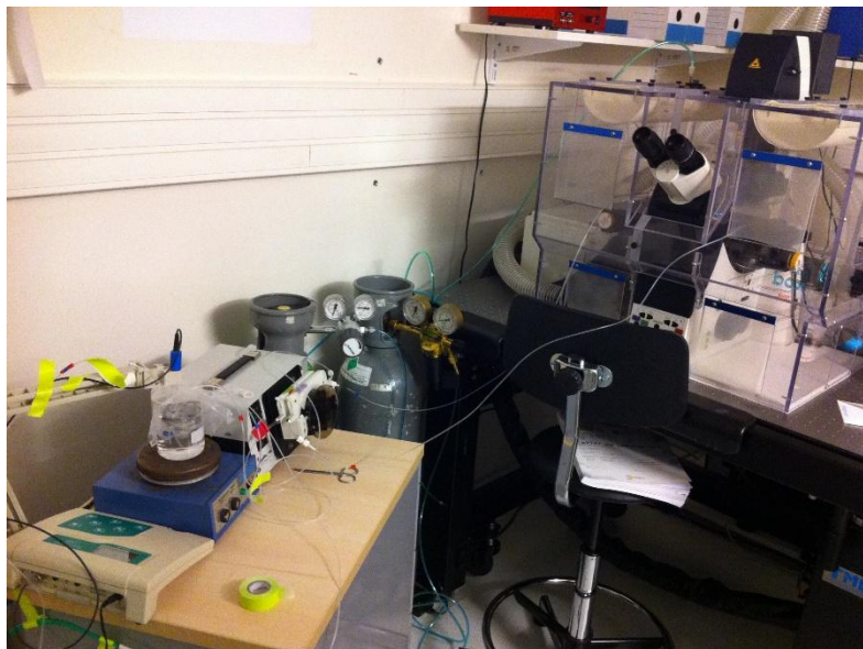
Figure 29.: Photo réalisée lors des mesures du pH intracellulaire des cardiomyocytes à différents niveaux de pH extracellulaire. On note la présence du pHmètre, de l'agitateur-réchauffeur, de la pompe centrifuge, des bouteilles d'oxygène et de dioxyde de carbone.
