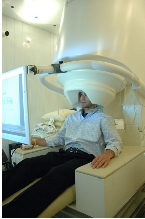
(a) Représentation d'un appareil de mesure utilisé en MEG. Crédits : NIMH Image library.
