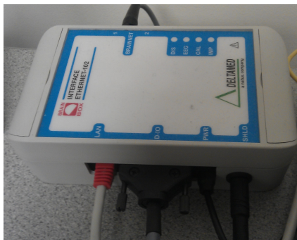
(c) Photographie d'un convertisseur analogique. Son rôle est de convertir le signal électrique enregistré en un signal numérique.
