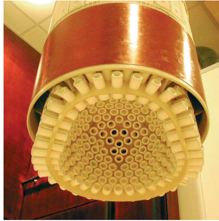
(b) Représentation des capteurs installés à l'intérieur du cylindre durant les enregistrements de MEG.
