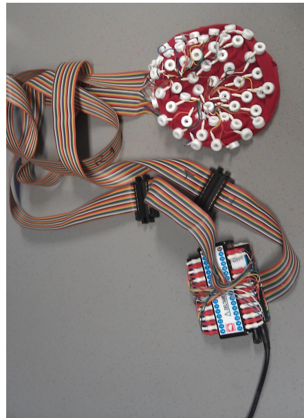
(b) Photographie d'un casque à 60 électrodes. Chaque plot blanc abrite une électrode. Le casque est relié à la boîte tête.
