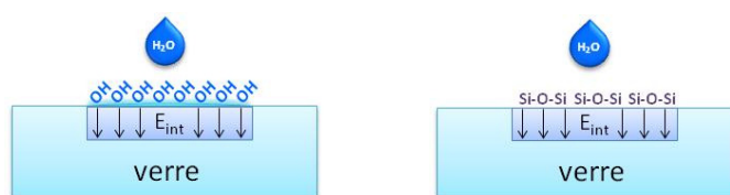
Figure 15 : Schémas des interfaces des lames polarisées étudiées respectivement sous air et sous argon.
