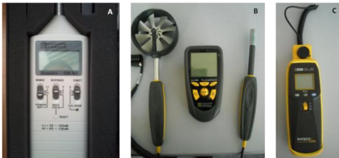
Figure A.3.1 : Les outils de mesures : le sonomètre (A), l'appareil multifonction de mesures physiques (B) (température, humidité et vitesse de l'air) et le luxmètre (C)
