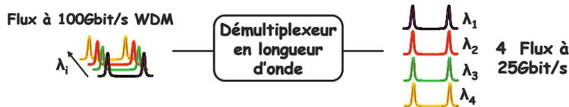
Figure 1.10 – Démultiplexage optique WDM.
