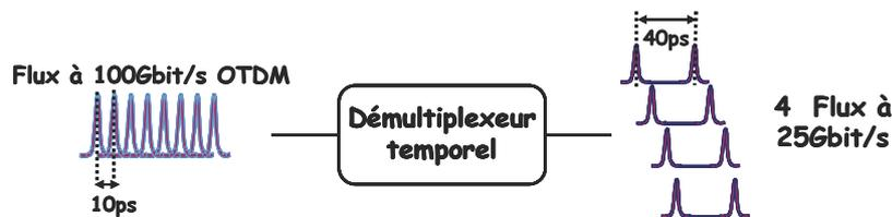
Figure 1.8 – Démultiplexage optique OTDM
