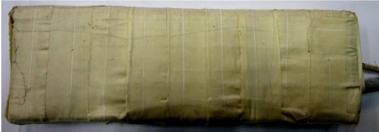
Figure III.19. Le Moteur linéaire revêtu par son étui isolant.
