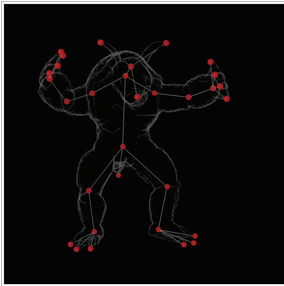
FIGURE 2.16 – Le modèle “Armadillo” approximé par un choix de points de contrôle définissant un squelette.
