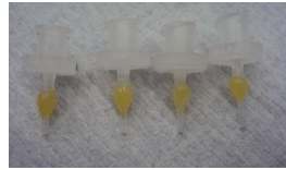
Figure 3.12: Buses en verre de diamètre : 50, 100, 150 et 200 \mu\text{m} (de gauche à droite) photo S. Vulgarakis
