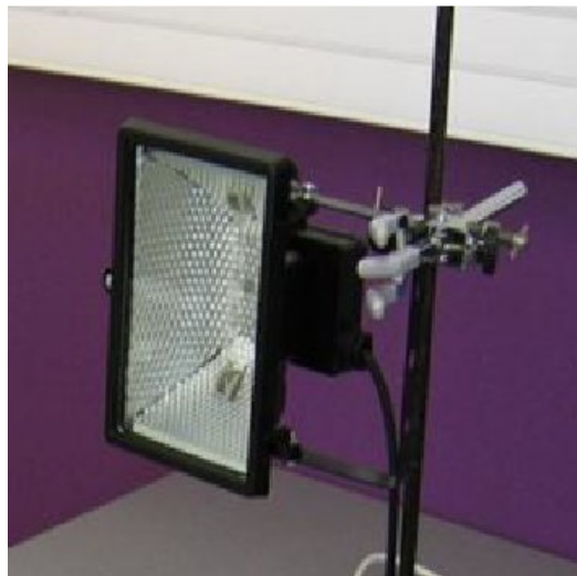
Figure 3.7: Projecteur halogène d'une puissance de 500 W
