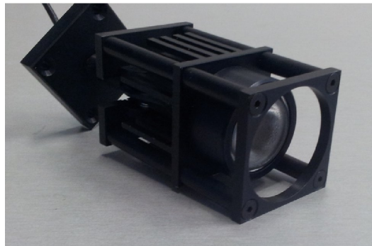
Figure 3.8: Système d'illumination à LED de puissance avec dissipateur thermique
