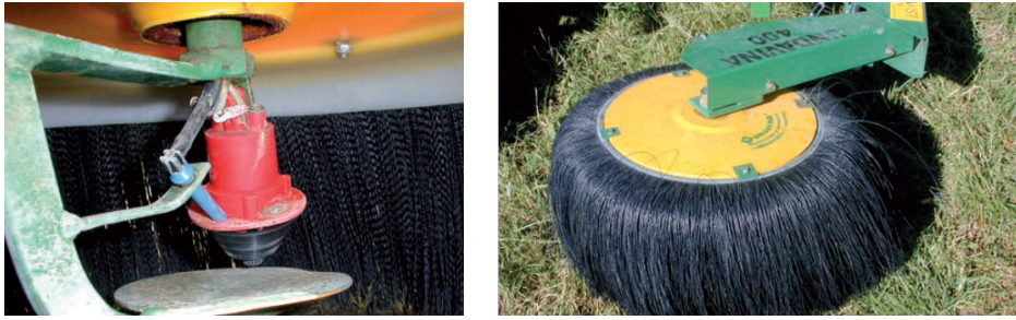
Figure 1.6: Détail et module de pulvérisation centrifuge (Source : IFV)
