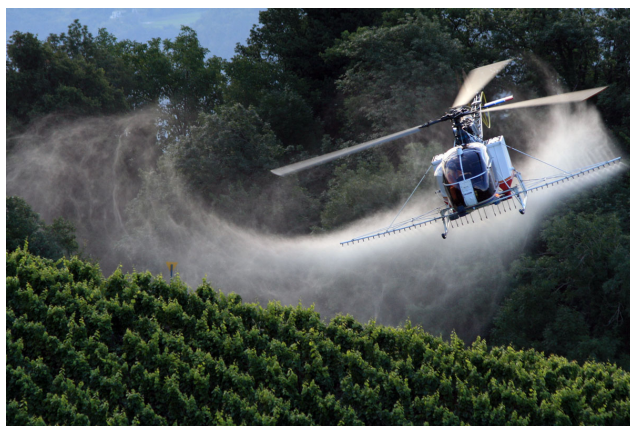
Figure 1.7: Pulvérisation par hélicoptère (photo Dominique Barras)
