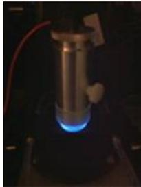
Figure 134: Lampe Nichia utilisée pour irradier des films recouverts d'AS
