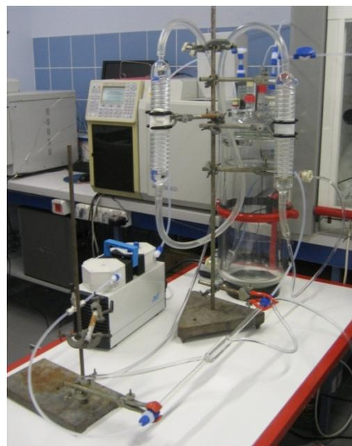
Figure 140: Schéma global du montage : 1) photo réacteur 2) réacteur batch 3) pompe 4) débitmètre 5) bain-marie 6 et 7) des colonnes de refroidissements 8) analyse GC 9) manomètre 10) hygromètre 11) entrée de l'air conditionné 12) sortie de l'air conditionné.
