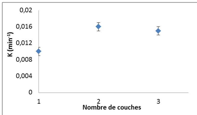
Figure 58: Constantes de vitesse de dégradation du MB sous irradiation UV en présence des films mésoporeux de  $\text{TiO}_2$  en fonction du nombre de couches.
