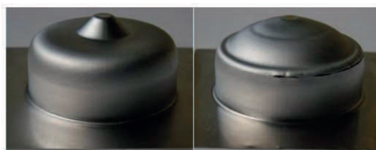
FIGURE 1.11 – Pièces à parois verticales formées par stratégie multi-passes [Skjoedt2008]
