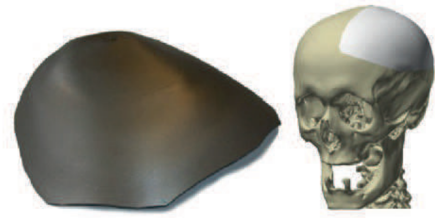
FIGURE 1.5 – Implant crânien en titane fabriqué par ISF [Dufflou2008]
