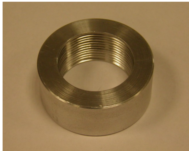
Figure VI.4 Le tube d'aluminium rainuré utilisé dans les essais sur les échantillons E1 et E2.
