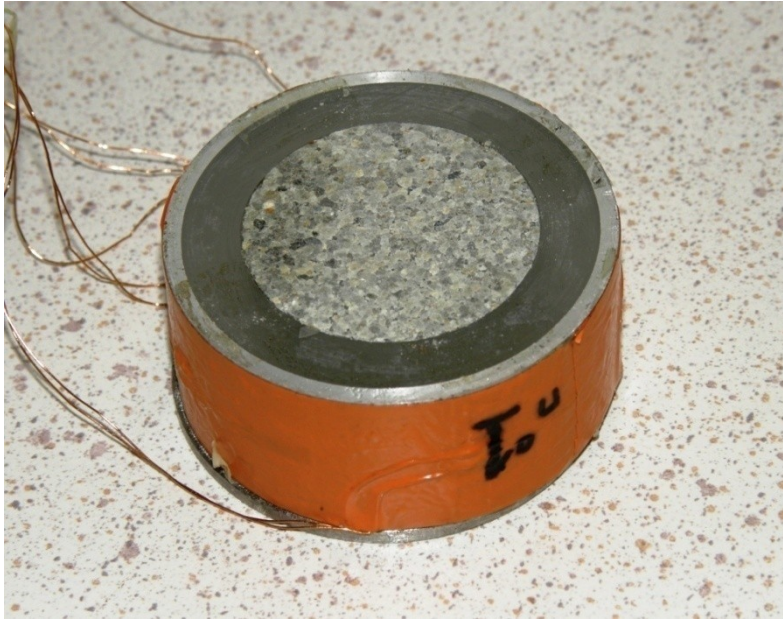
Figure II.11 Un des petits tubes utilisés pour l'essai de gonflement avec pression de gaz, avec un échantillon de bentonite/sable entièrement saturé et gonflé à l'intérieur.
