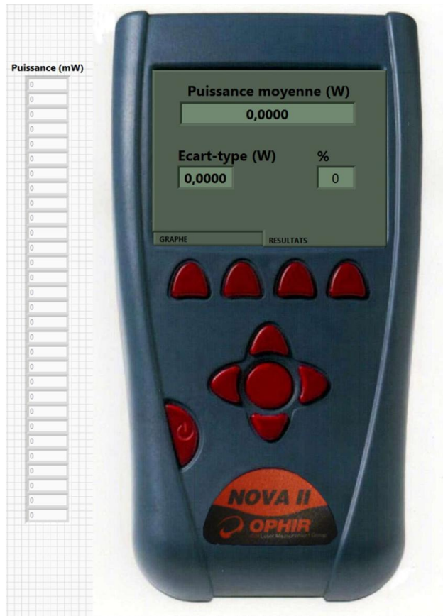
Figure III-29. Interface du VI de la mesure de puissance laser
