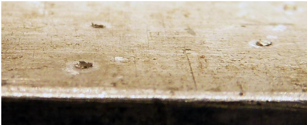
Figure IV-7. Détail sur les remparts formés par l'aluminium ablaté à l'air libre par le laser UV
