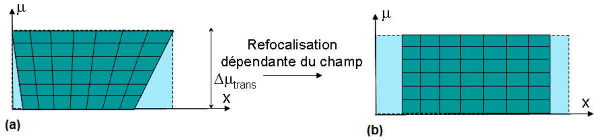
Figure 3-15: Processus de correction numérique d'une défocalisation variant avec le champ x , vue dans l'espace (x, \mu) (équivalent au couple (x, \theta_x) de la Figure 3-4). (a) Cas d'une image brute d'une surface inclinée (la défocalisation s'accroît avec x ). (b) Après correction numérique : l'espace (x, \mu) a été « redressé » (on a fait une refocalisation adaptée en chaque point du champ) : l'image est alors refocalisée sur une surface qui n'est pas perpendiculaire à l'axe optique.
