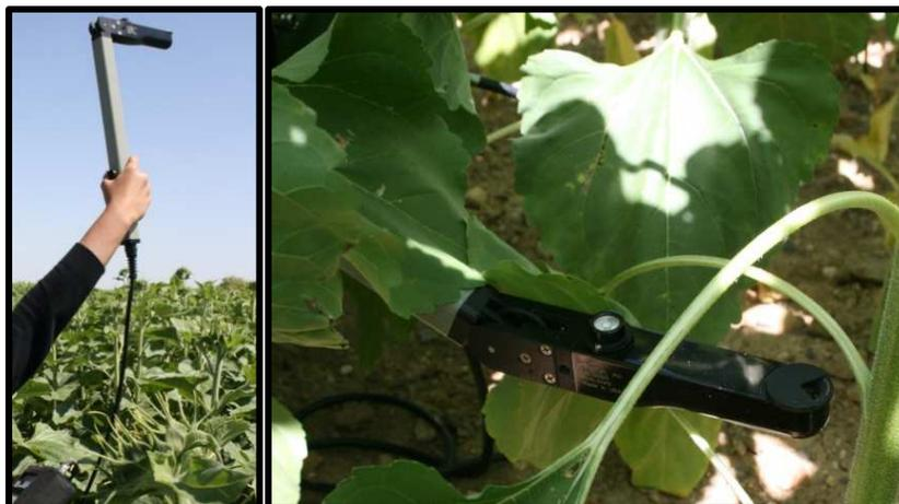
**Figure III. 3.** Mesure de l'indice foliaire avec un LAI-2000
