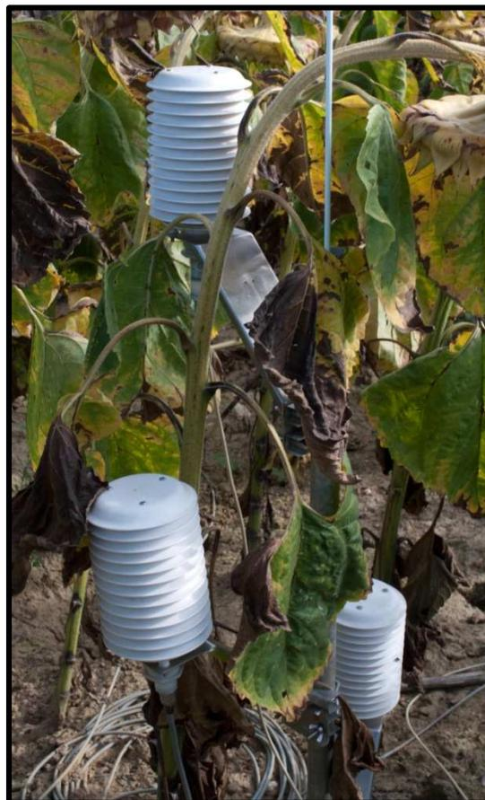
Figure III. 2. Thermohygromètres placés dans le couvert
