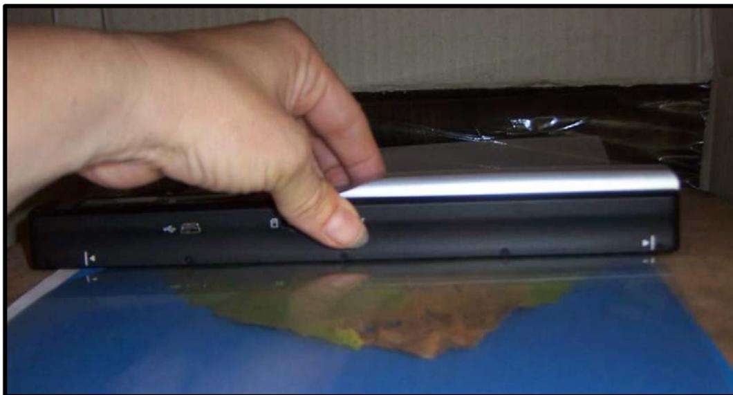
Figure III. 8. Quantification de la surface foliaire nécrosée par scanner sur fond bleu
