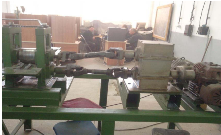
Figura 5.5. Laminorul folosit pentru deformarea plastică a AMF utilizate în această teză
