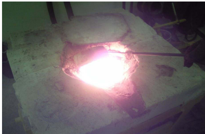
Figura 4.5 Baia metalica a unui aliaj cu memoria formei Cu-Zn-Al
