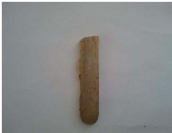
Figura 5.2. Probă turnată din AMF Cu-Zn-Al ce urmează a fi suspendă laminării
