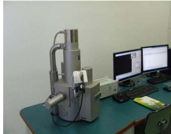
Figura 3.3 Microscop cu scanare cu electroni – a) principiul de funcționare, b) microscopul folosit pentru analiza microstructurală
