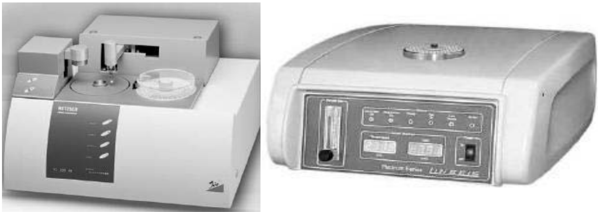
Figura 3.10. Fotografii ilustrând două modele de calorimetre cu scanare diferențială
