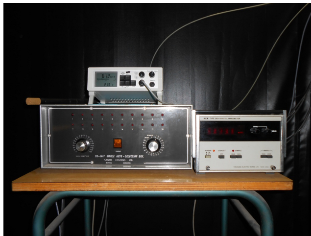
FIGURE 2.5 – Thermo-hygromètre DOSTMANN T870, Mesures de pressions : Sélecteur Bexhill 20 voies, Manomètre YAW 2654
