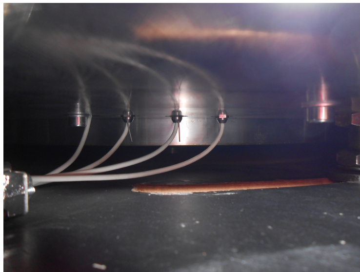
FIGURE 2.25 – Montage des capteurs instationnaires sur le moyeu
