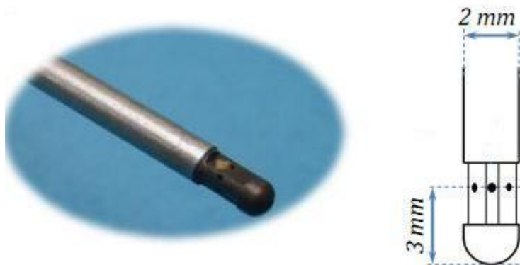
FIGURE 2.11 – Photo et schéma de la sonde 3 trous
