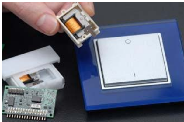
Figure I.14: Interrupteurs à convertisseurs électromagnétiques – EnOcean
