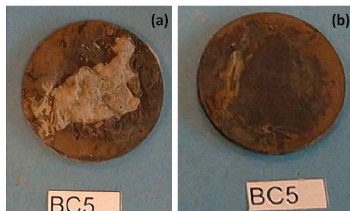
Figure I-19 : aspect d'un échantillon d'acier carbone après extraction avant nettoyage (a) et après nettoyage (b) (Foct, 2006)
