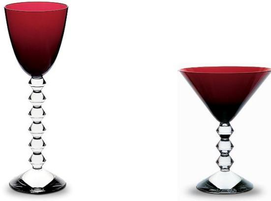
Figure 5-3 : Verres de couleur « rubis » de la gamme Vega de Baccarat obtenu par incorporation de nanoparticules d'or dans la matrice vitreuse.
