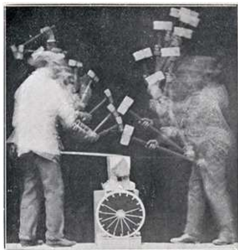
Fig. 3 Chronophotographie du travail au marteau. in C. FREMONT, « Les mouvements de l'ouvrier dans le travail professionnel », in Le monde moderne , 1895, t. I, n° 2, p. 193.
