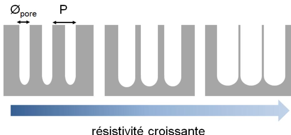
Figure 73 : Evolution du diamètre des macropores ( $\varnothing_{\text{pore}}$ ) en régime de croissance stable pour une période ( $P$ ) donnée en fonction de leur résistivité.
