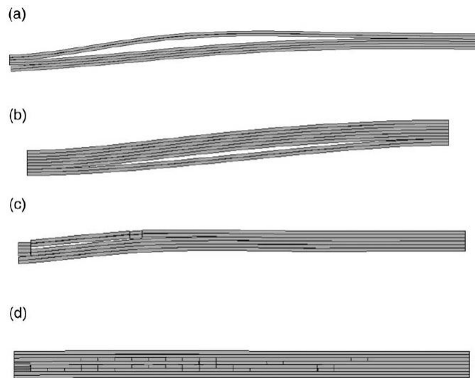
Figure 1.3: Délaminage (a et b), Délaminage et rupture (c et d) [12]
