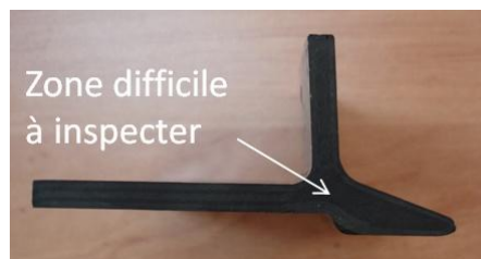
Figure 3.45 : raidisseur en carbone/époxyde
