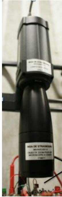
Figure 2.7 : Mesure de l'émissivité des échantillons (Caméra IR couplée avec un objectif pour microscopie)
