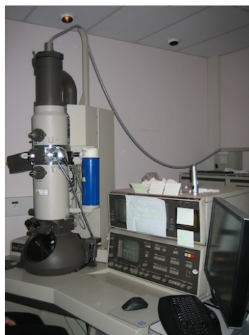
Figure 40 : Microscope électronique à transmission utilisé à la plateforme de l'IBS. CM12 120kV LaB6 (Philips).
