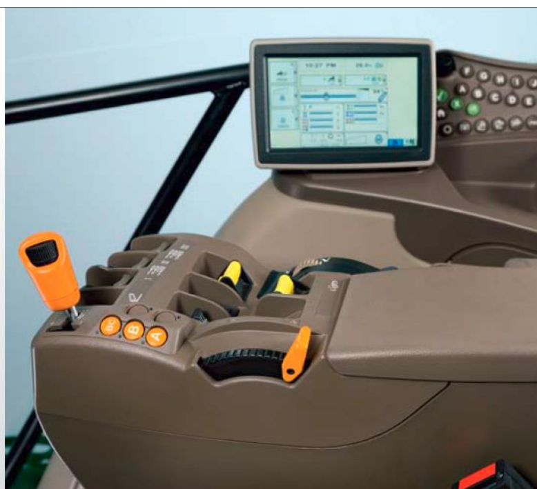
La consolle « CommandCenter GreenStar 3 » et son nouvel écran tactile en option sont compatibles ISOBUS et prennent en charge l'automatisation de la combinaison tracteur-outil.
