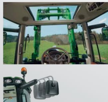
Rétroviseurs télescopiques chauffants à réglage électrique depuis l'intérieur de la cabine proposés en option.
