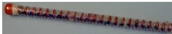
Figure 5.2. Tube cylindrique en Plexiglas gradué permettant d'isoler l'antenne in-body du liquide humain.
