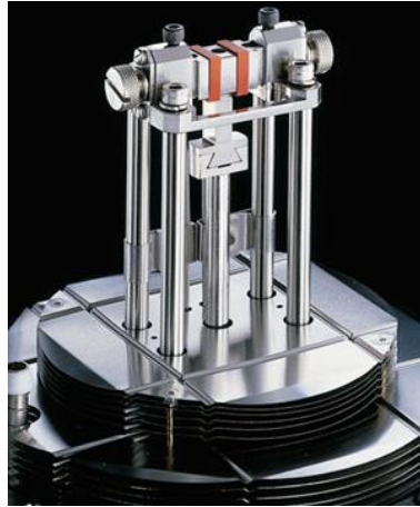
Figure B.I-13 : Photo de l'outil de cisaillement en DMA
