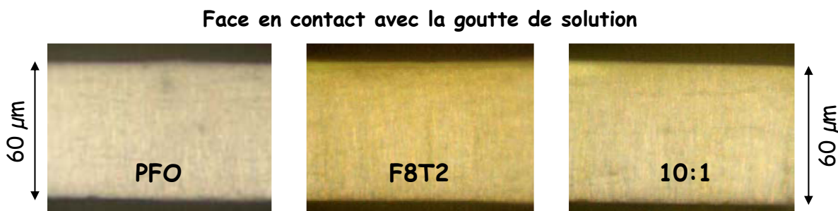
Figure 4. 8 – Images optiques de trois coupes de membranes imprégnées par les solutions de PFO, de F8T2, et de PFO:F8T2 à 10:1. La face de la membrane en contact avec la goutte de solution lors de la mise en forme se situe en haut. Dans chaque cas aucun film de surface n’est visible à l’échelle de la résolution optique.
