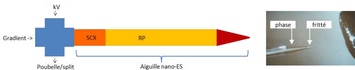
Figure 17. Multidimensional protein identification technology (MudPit). A gauche : l'aiguille nanospray est remplie par un segment de phase SCX et par un segment de phase inverse. Une union permet d'appliquer d'une part la tension de spray (kV) et d'autre part le débit (gradient). A droite : la phase est retenue par un fritté constitué dans le dernier mm de l'aiguille nanospray.
