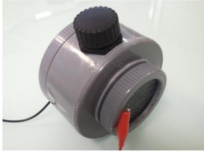
Figure II.39 Photographie de la biopile fabriquée par N. Degrenne
