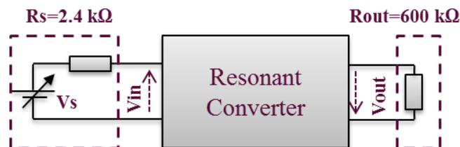
Figure II.29 Test expérimental du convertisseur résonant en utilisant un modèle d'émulation de la rectenna
