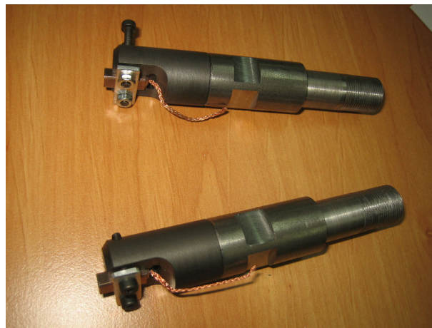
Figure II.35 - Porte-balais spécifiques isolés électriquement pour le Tribomètre bi-pion du LISMA
