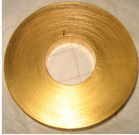
Figure III.2 - Exemple de réalisation d'un disque destiné au tribomètre bi-pion. Matériau: Cuivre revêtu d'Or.
