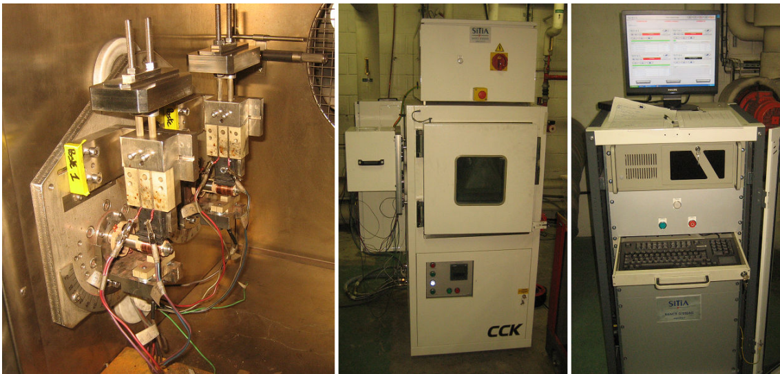
Figure III.4 - L'Electro-Tribomètre n°2 VALEO À Gauche - Vue de l'enceinte où se trouvent les deux arbres porte-monobague pour deux essais simultanés. Au Centre - Partie Opérative du banc avec accès à l'enceinte où température et hygrométrie sont contrôlées. À Droite - Partie Commande du banc.
