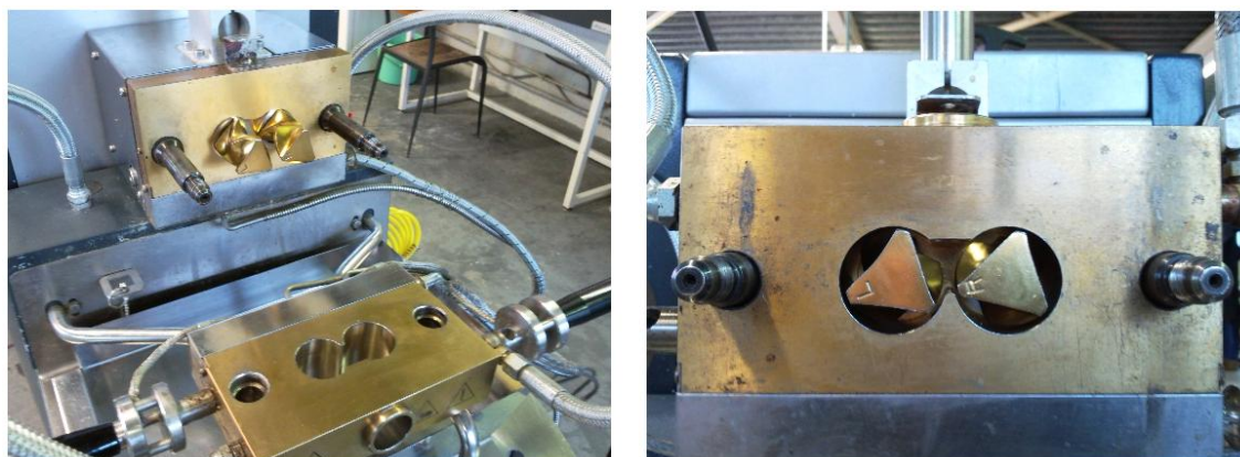
Figure 82 : Mélangeur interne Rheomix Thermo Haake 600 équipé de pâles roller rotor, disponible à l'IMP@UJM 1
