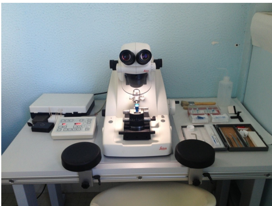
Figure 13 Photographie du microtome Leica UC6 utilisé
