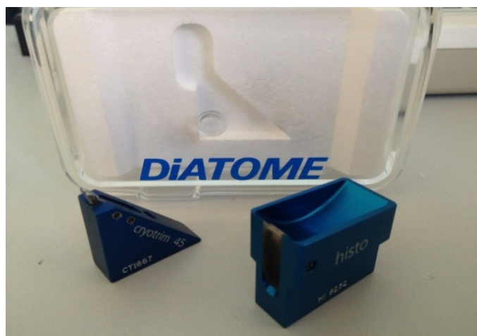
Figure 14 Photographie des couteaux en diamant utilisés pour les coupes : Cryotrim 45 pour préparation des blocs à gauche, Histo 45 pour la coupe et la collecte des coupes microtomées à droite
