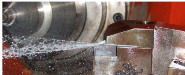
FIGURE I.25 – Vue d'un outil avec assistance jet d'eau haute pression (Braham-Bouchnak (2010a))
