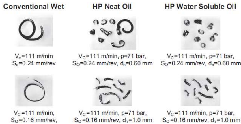
FIGURE I.27 – Influence de la lubrification et du type du lubrifiant sur la fragmentation du copeau (Nandy et al. (2009))
