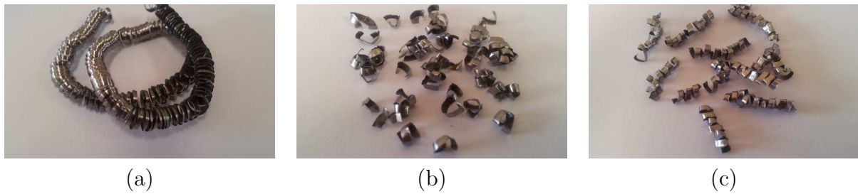
FIGURE II.39 – Morphologie du copeau à V_c=88 m/min : (a) lubrification conventionnelle, (b) P=50 bar et T=1min, (c) P=50 bar et T=12 min
