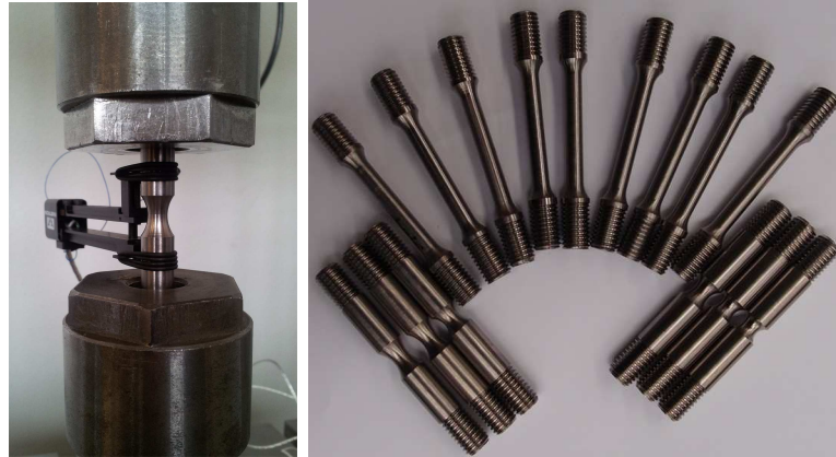
FIGURE III.29 – Montage de traction et les éprouvettes utilisées
