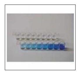
Figure I.11 : Réglettes ELISA en polycarbonate avant et après ajout du TMB ayant réagi avec la  $HRP-H_2O_2$  sur une gamme de concentrations en agent pathogène (sordalab.com)
