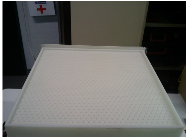
Figure IV-10 Partie des buses (à droite le détail des trous d'injection et d'extraction)
