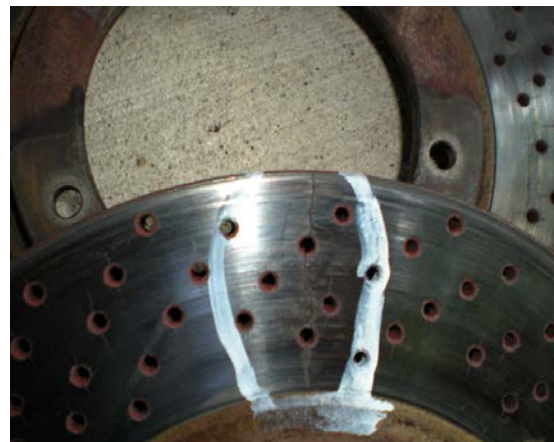
Figure 2.6 : Fissures sur un disque de frein
