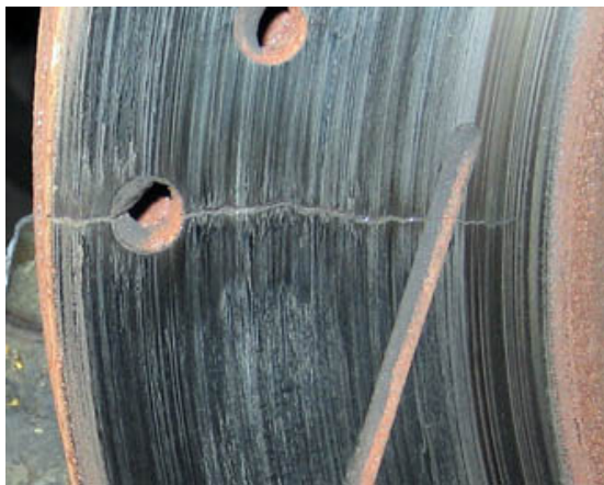
Figure 2.6 : Fissures sur un disque de frein
