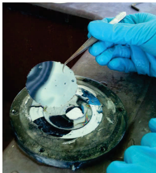
Figure II. 5 : Couche de silicium poreux (Sip) détachée du wafer d'épaisseur 90 \mu\text{m} vers le centre de la zone d'attaque et de 80 \mu\text{m} sur les bords.
