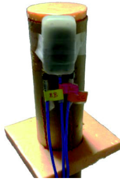
Figure 82 - Antennes IFAs + Patch fixées au support en carton
