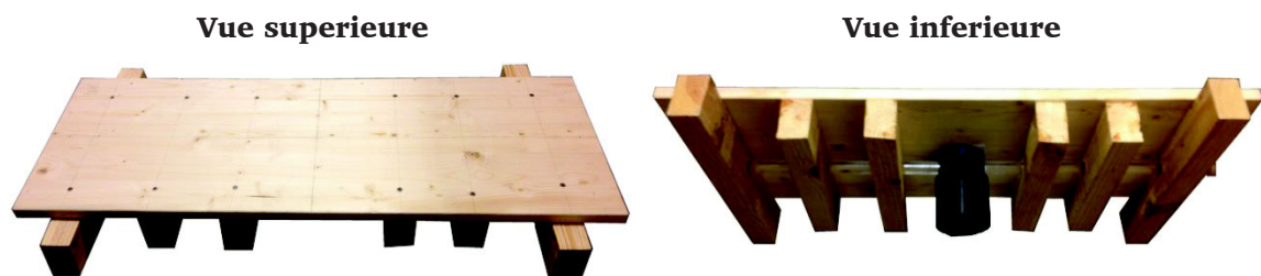
Figure 54 - Support en bois pour les mesures de diagramme de rayonnement
