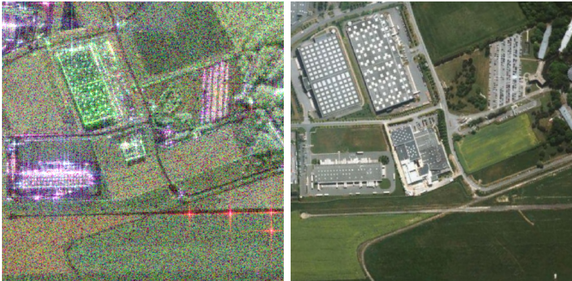
(a) Brétigny dans la base de Pauli : S_{HH} - S_{VV} , S_{HV} , S_{HH} + S_{VV}
