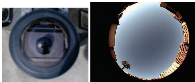
FIGURE I.4. Une camera avec objectif de type Fisheye à gauche et photo du ciel prise avec la caméra à droite
