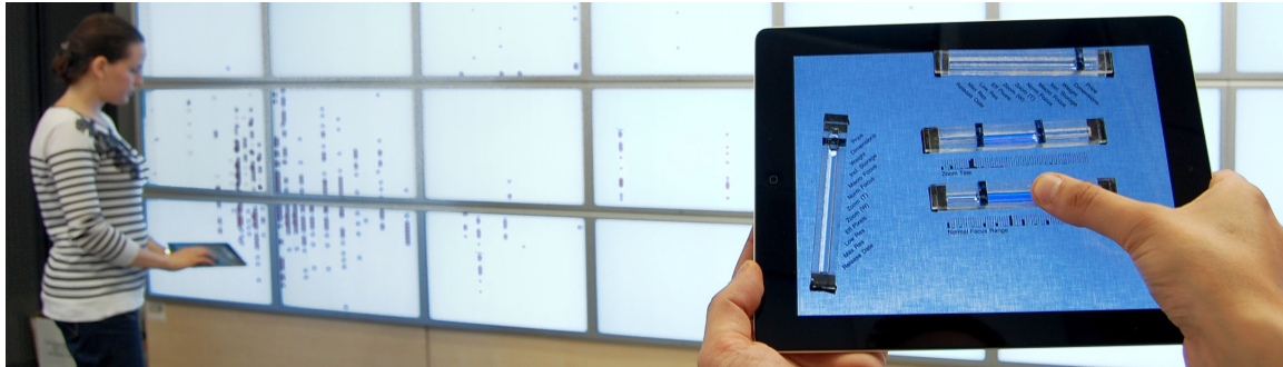
Figure 4: Télécommande tangible personnalisable pour interagir avec un nuage de points sur un mur d'écrans.
