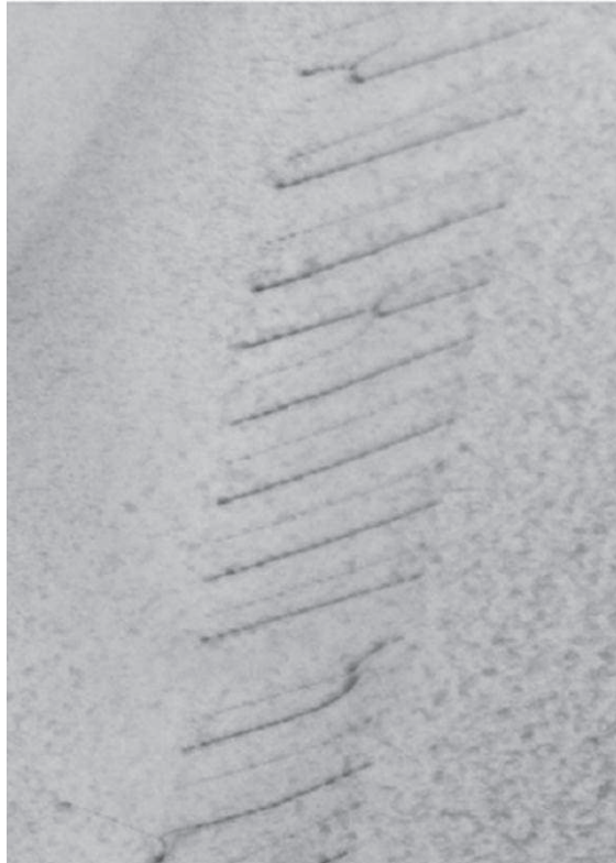
Figure I.10 – Micrographie d'un mur de dislocations dans le \text{Ti}_4\text{AlN}_3 . L'observation de deux contrastes différents suggère que ce mur est constitué de deux types de dislocations avec deux vecteurs de BURGERS différents. Ces derniers n'ont pas été déterminés [35].
