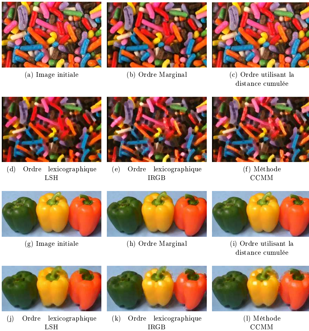
FIGURE 2.28 – Résultats d'érosion obtenus avec différentes méthodes et un élément structurant carré de taille 5 \times 5 pixels.
