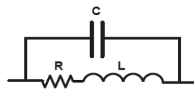
Fig. n°II.8 : Modèle RLC d'une inductance planaire
