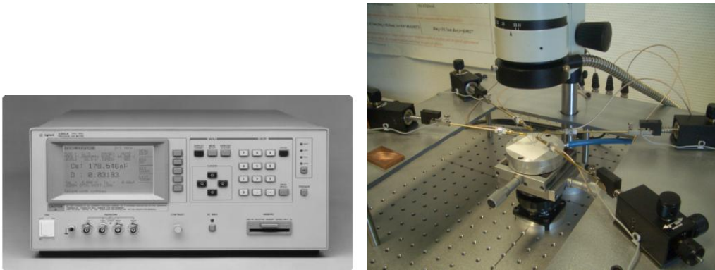
Fig. N°IV.3 : Dispositif expérimental : a°) LCRmètre HP 4284A ; b°) Testeur 4 points
