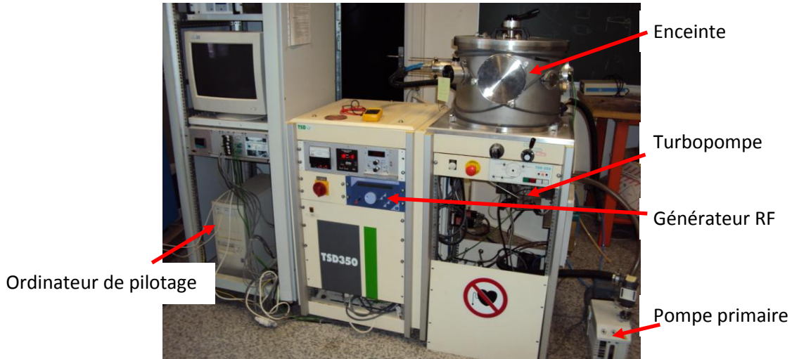
Fig. n°III.11 : Dispositif expérimental de pulvérisation cathodique RF
