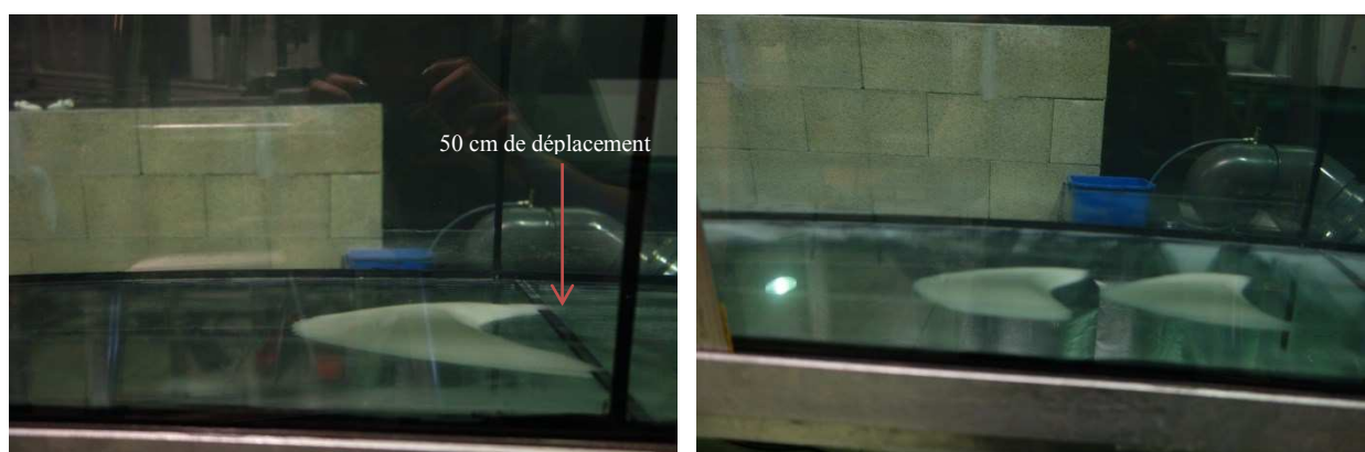
Figure V- 12 À gauche : Formation d'une forme de croissant à partir d'un tas de particules. ( U_c=0.5 m/s). À droite : Succession de deux structures géomorphologiques issues de deux tas différents mis en mouvement l'un après l'autre
