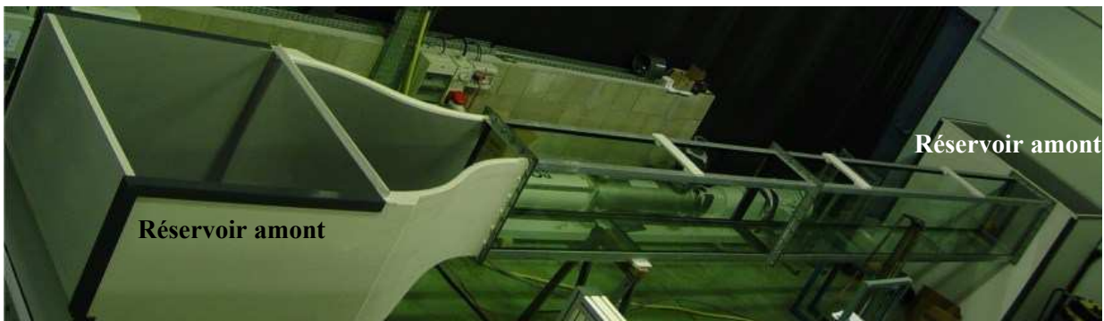
Figure V- 2 Dispositif expérimental dédié aux mesures du transport de particules : Canal hydro-sédimentaire
