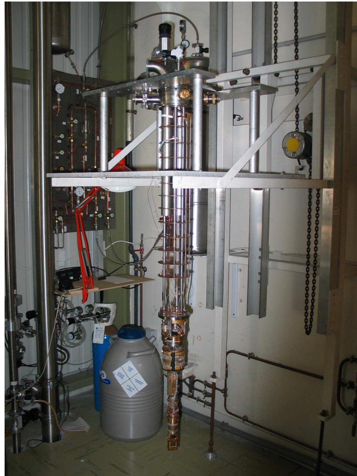
Figure 2.8 – Photographie du cryostat à dilution utilisé pour les mesures de transport à basse fréquence.
