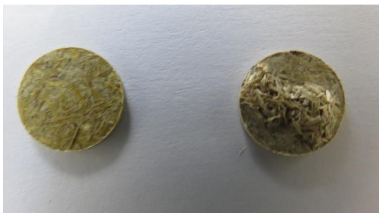
Figure 52 : Pastille de paille de blé avant (gauche) et après (droite) dépôt de la goutte d'eau
