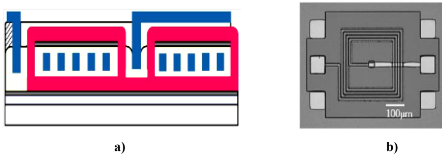
Figure I.20: Schéma en coupe (a) et photographie de l'inductance sandwich réalisée (b) [52].
