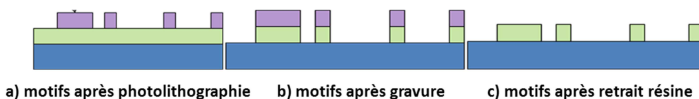
Figure 62 : Formation de motifs dans une couche par photolithographie/gravure
