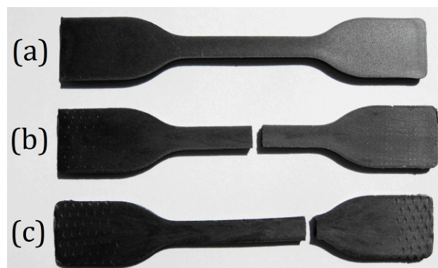
Figure V-21 : Allure des éprouvettes de PA6/Gs-20 non testé (a) et testés à température ambiante (b) et à température cryogénique (c)
