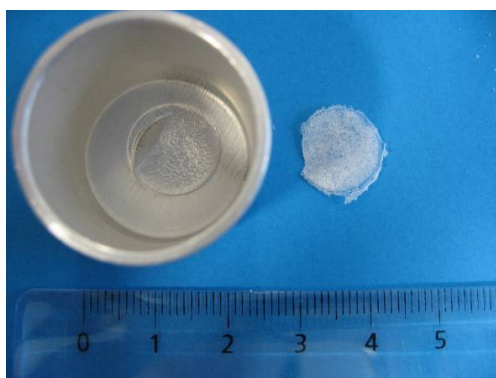
Figure III-25 : Correspondance géométrique entre les résidus de type b et la zone d'impact de la coupelle LOX
