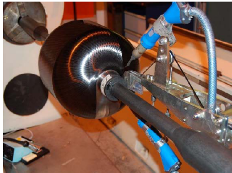
Figure 2 : Bobinage de la structure composite d'un démonstrateur [1]
