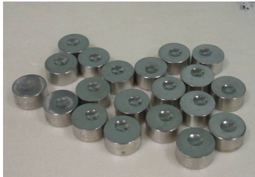
Figure C-2 : Disques en inox 304L utilisés pour l'étalonnage du banc d'essai
